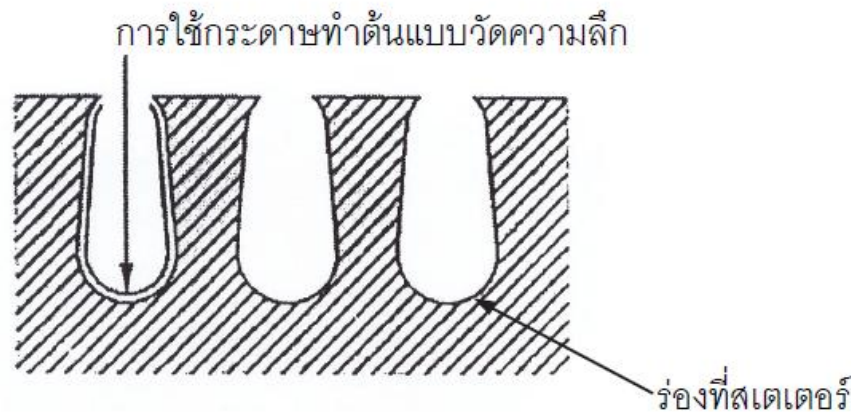
รูปที่ 9.5 การใช้กระดาษวัดความลึกรอบร่องเพื่อเป็นต้นแบบ
