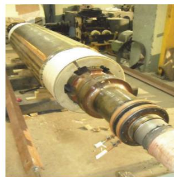
(ง) หน้าขั้วแม่เหล็กจะราบเรียบเป็นรูปทรงกระบอก
