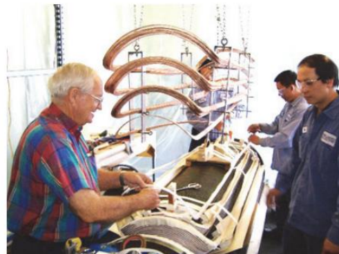
(ข) การบรรจุขดลวดสนามแม่เหล็กลงในร่อง
