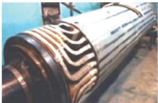
(ค) ขดลวดสนามแม่เหล็กบรรจุลงในร่องที่สำเร็จแล้ว
